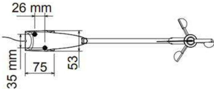
Le support doit être installé sur un plan horizontal, propre, lisse et plat. Vous fixerez avec deux vis **M5X35mm** (non fournies) de telle façon que la tige de la girouette soit dans l'axe du bateau. Le capteur sera ensuite vissé à sa prise et bloqué par un collier nylon (fourni)
